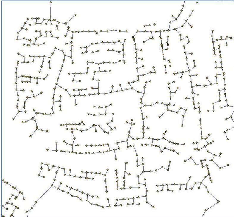
**Abbildung 16: Spannbaum als kürzeste Verbindung zwischen den Hauskoordinaten**
